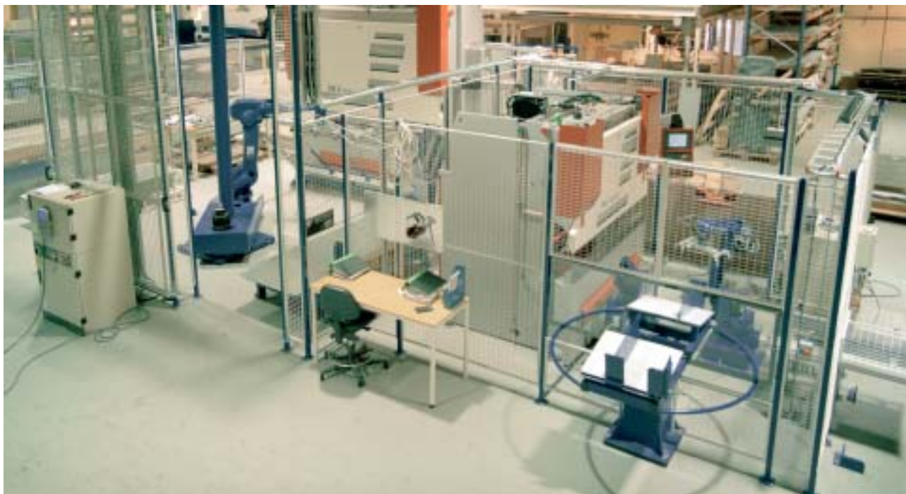
Motomans nyckelfärdiga celler med robotbetjäнад kantpressning för valfritt kantpressfabrikat. Systemen innehåller olika alternativ för att hämta inkommande plåtmen och placera färdiga detaljer på pall eller transportband.
