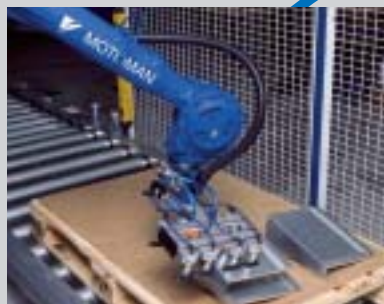
5. Efter avslutad bockning mönsterlägger roboten detaljerna på utpall eller transportband.
