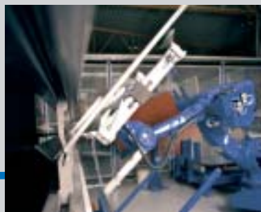
3. Roboten tar plåten till kantpressen och börjar bockningen.
