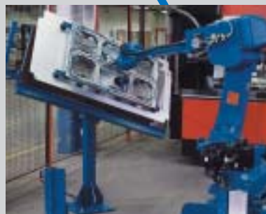
2. På orienteringsbordet hamnar plåten automatiskt i rätt position inför bockningen.
