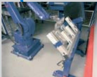
4. Omgreppsstationen, framför pressen, kan användas om roboten behöver byta grepp mellan olika bockar.
