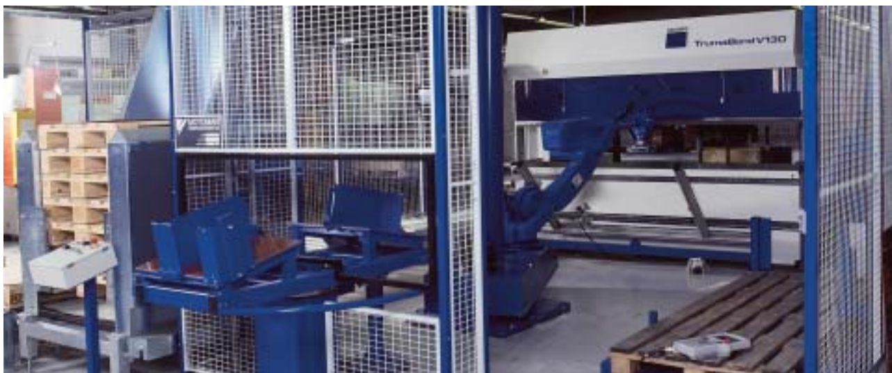
Det vridbara magasinbordet har två stationer och kan laddas medan cellen är i drift.
